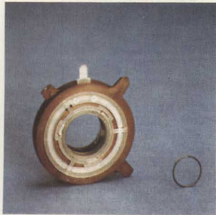
Fig. 1 - Prima dell'introduzione del sistema 30AX, la convergenza statica veniva messa a punto con l'unità multipolare esterna fissata sul collo del cinescopio. Con l'introduzione del sistema 30AX, questo circuito è sostituito da un anellino magnetizzato in sede di coliaudo del tubo in maniera da presentare nei confronti dei fasci, campi magnetici a 2, a 4 e a 6 poli, aventi l'intensità e la direzione richiesta dalle esigenze di convergenza statica del tubo in cui è montato.
