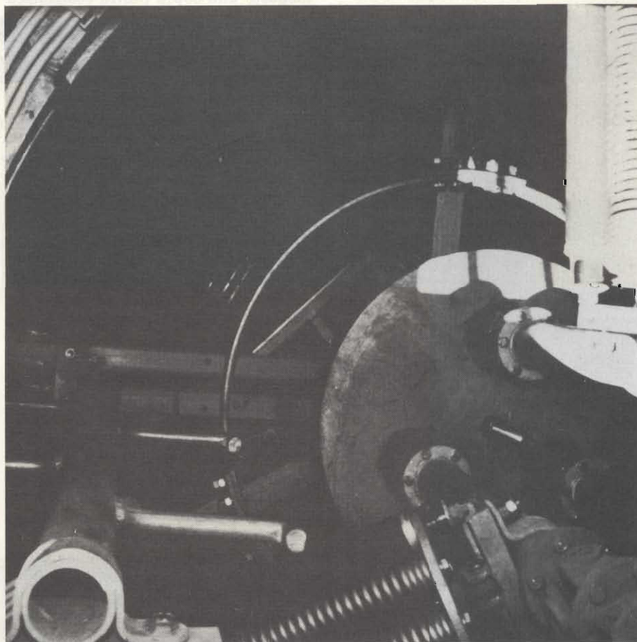
Fig. 3. Smorzatore meccanico di oscillazioni nell'esecuzione pratica (foto Kathrein)
