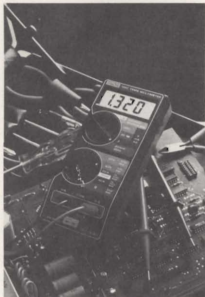
DMM a TRMS con rivelazione delle temperature.
