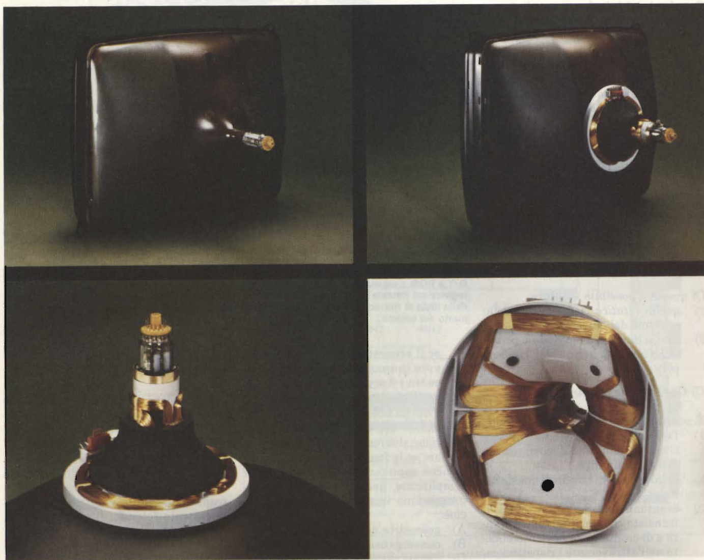
Fig. 3 - Cinescopio e bobina di deflessione del sistema 30AX. Questo sistema, attuando automaticamente la convergenza statica, dinamica e la purezza dei colori, elimina tutte le complicate operazioni di taratura necessarie nei vecchi televisori (presenti in parte anche nel già progredito sistema 20AX), al punto da rendere il montaggio del globo di un televisore a colori più facile e veloce di quello di un televisore in bianco e nero.
